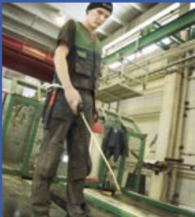
Oppisopimuskoulutuksella elementtiasentajaksi opiskellut Timo Huhtanen öljyää muottia.
